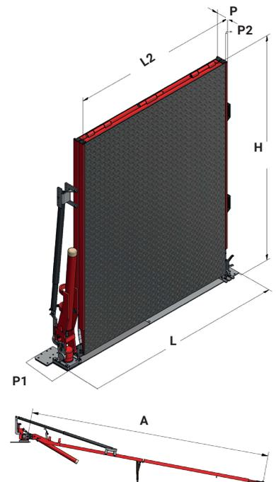
Rampe munie d'un vérin mécanique (ressort comprimé) permettant une manipulation sans effort. Le ressort comprimé est bien plus efficace qu'un compas à gaz, d'où notre choix technique en ce sens.
