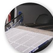
Bande articulée de raccordement à la plateforme de chargement
