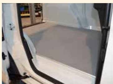
Plancher alvéolaire renforcé
